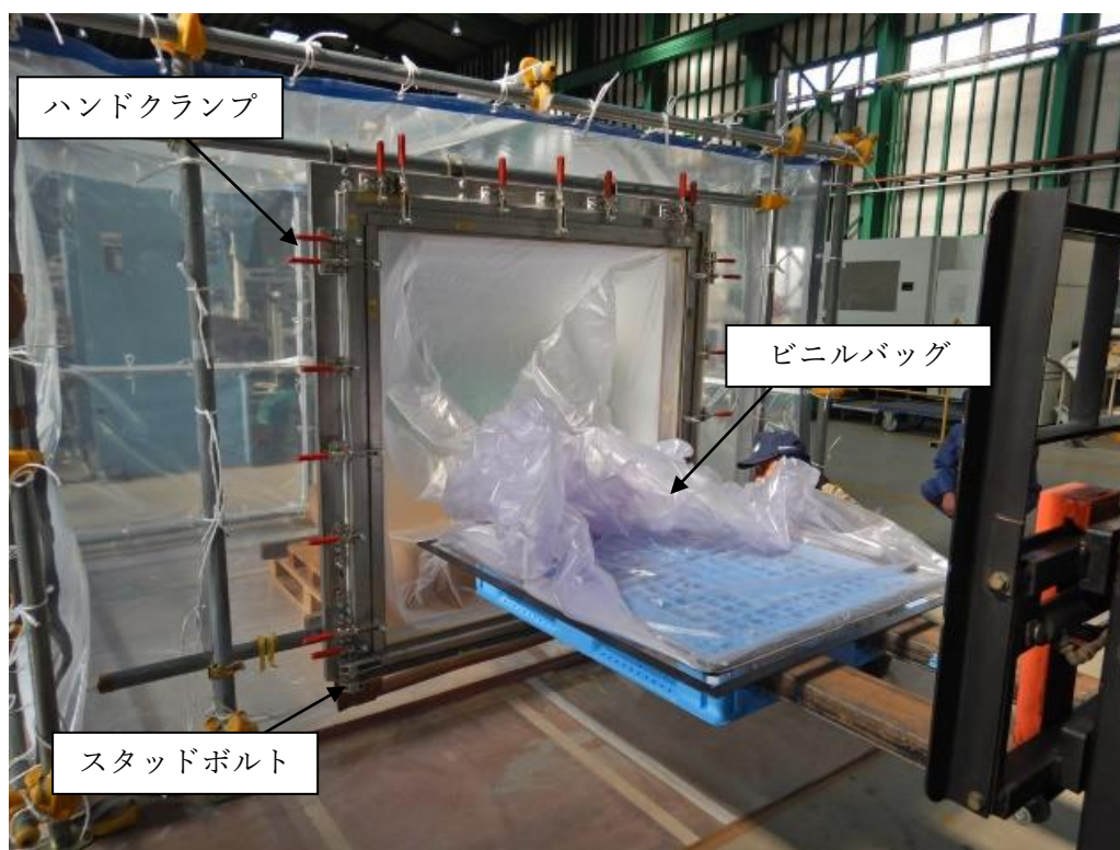
写真 令和4年度に実施したモックアップ試験
