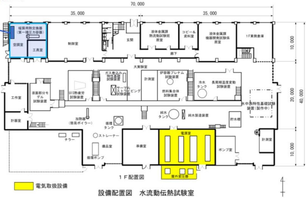
図1 水流動伝熱試験室空調制御盤設置位置 (No.1~No.4)
