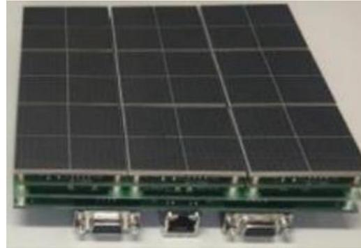
図 2 MPCC 部の構成部品(左：GSO 結晶をラッピングし配置、右：MPCC と MPCC 用回路)
