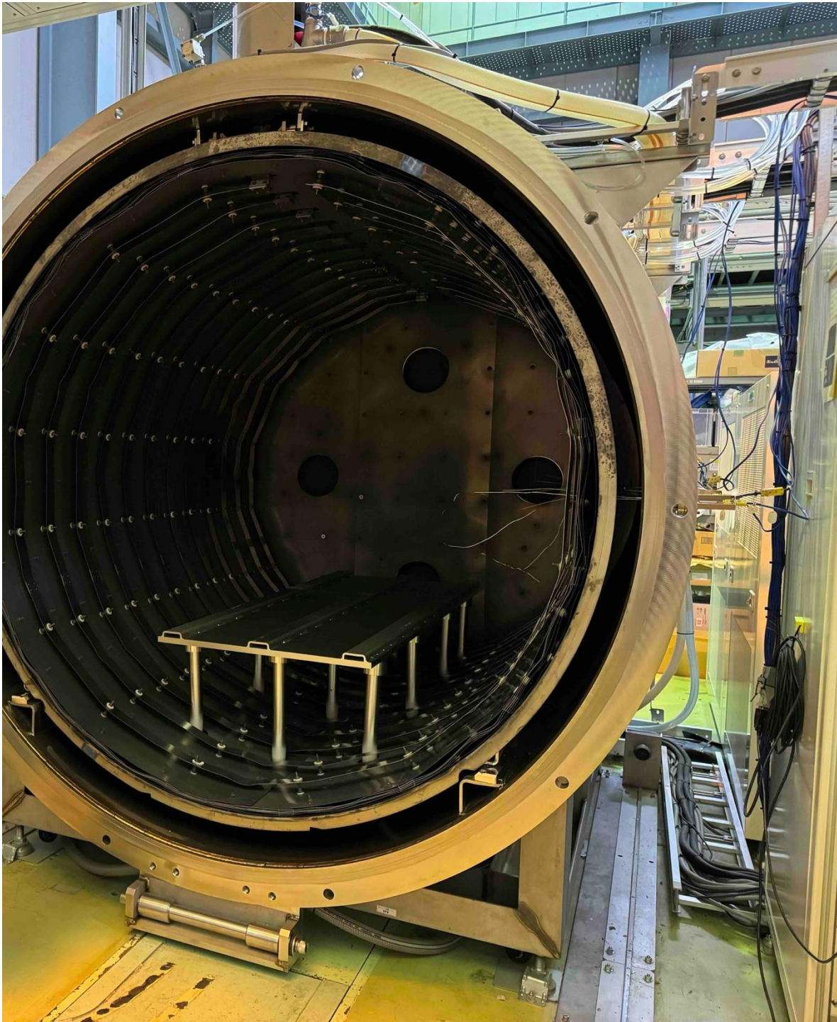
参考図：真空加熱炉内部。3本のヒータをまとめて1系統とする。 ヒータ直径はおよそ1620mmである。
