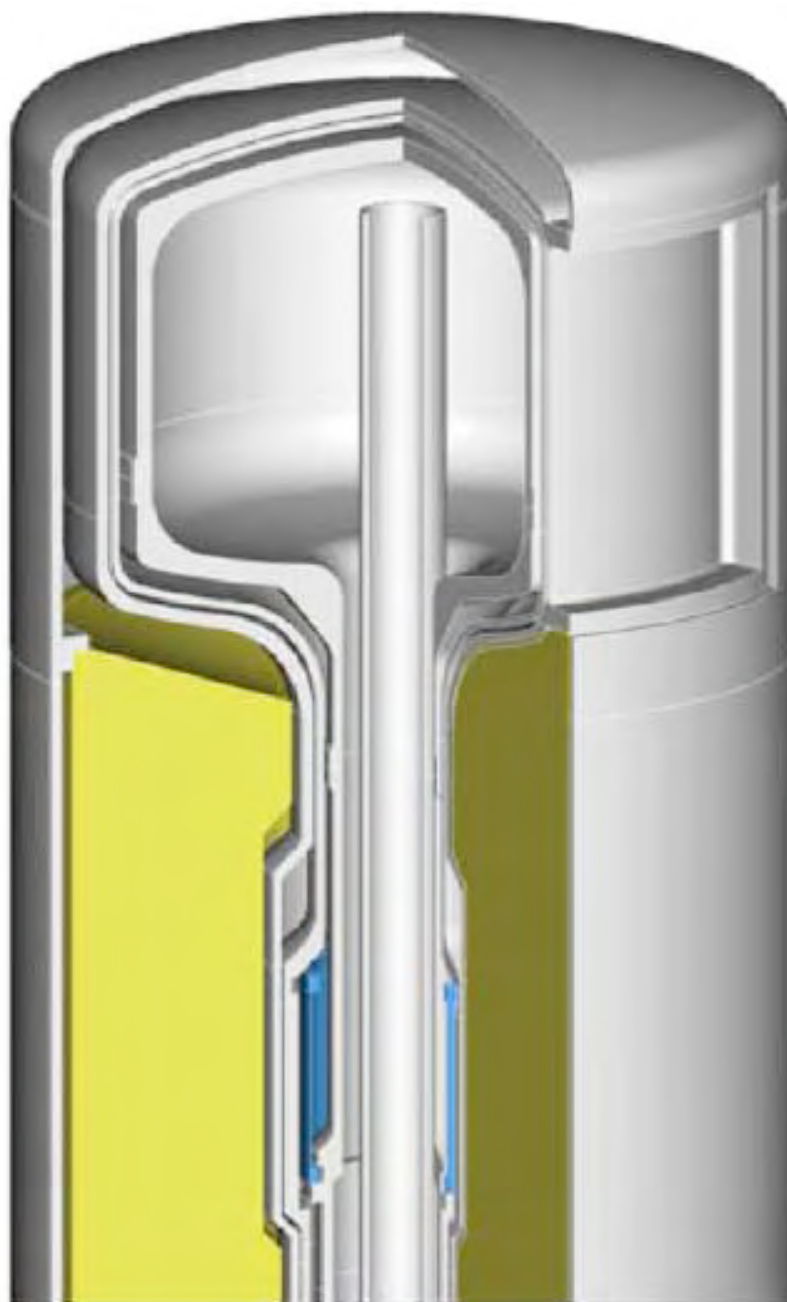
図 1.6 結合型減速材ヘッド詳細図（初号機のもの）.
