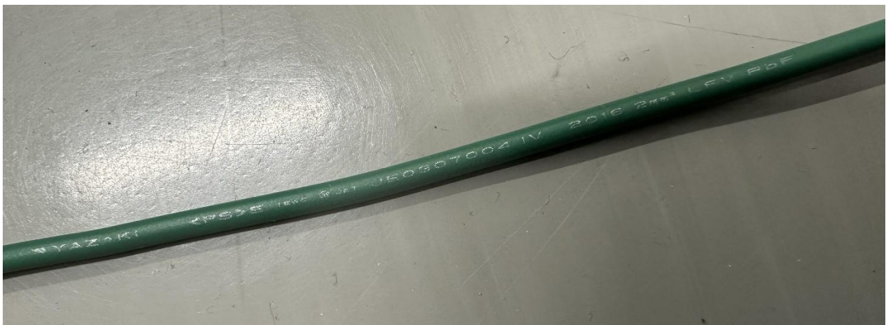
図 4. アース線表面の印字箇所写真
