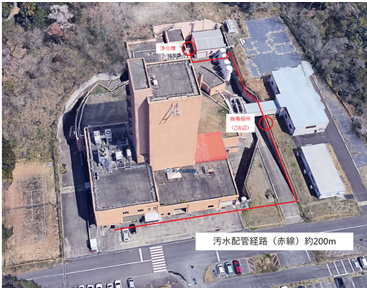
図 1 汚水配管の経路 概観図
