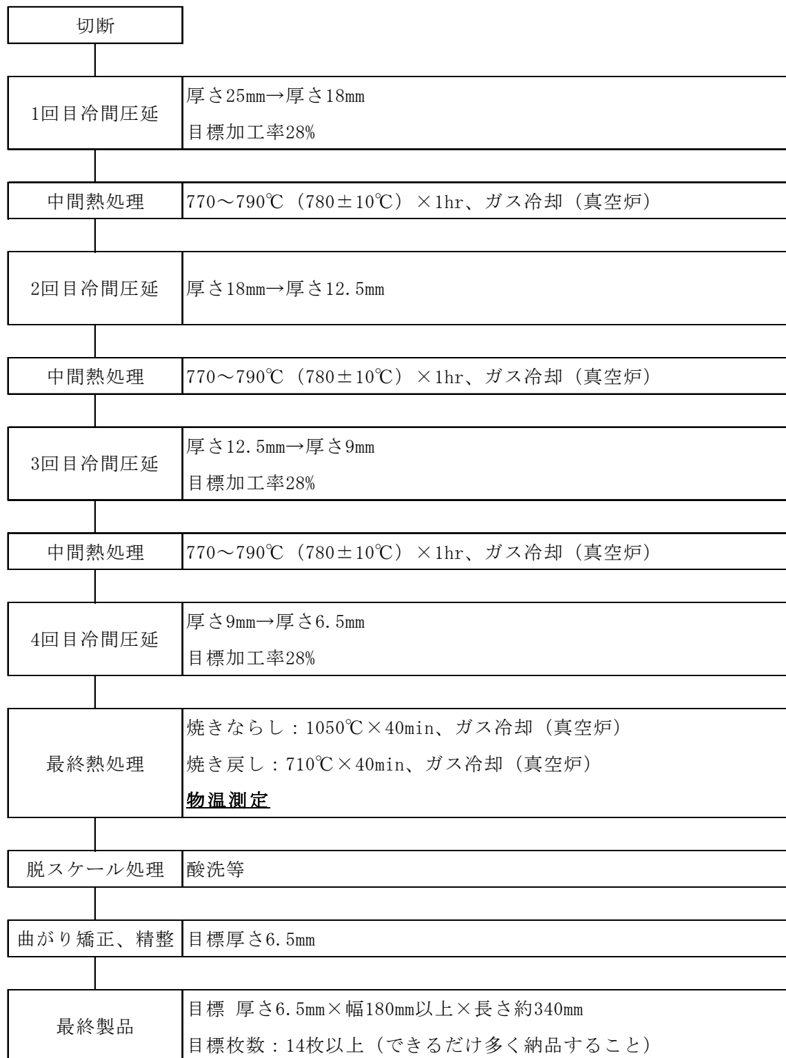
図 3. ラップ管模擬圧延熱処理材の製作工程(例)
