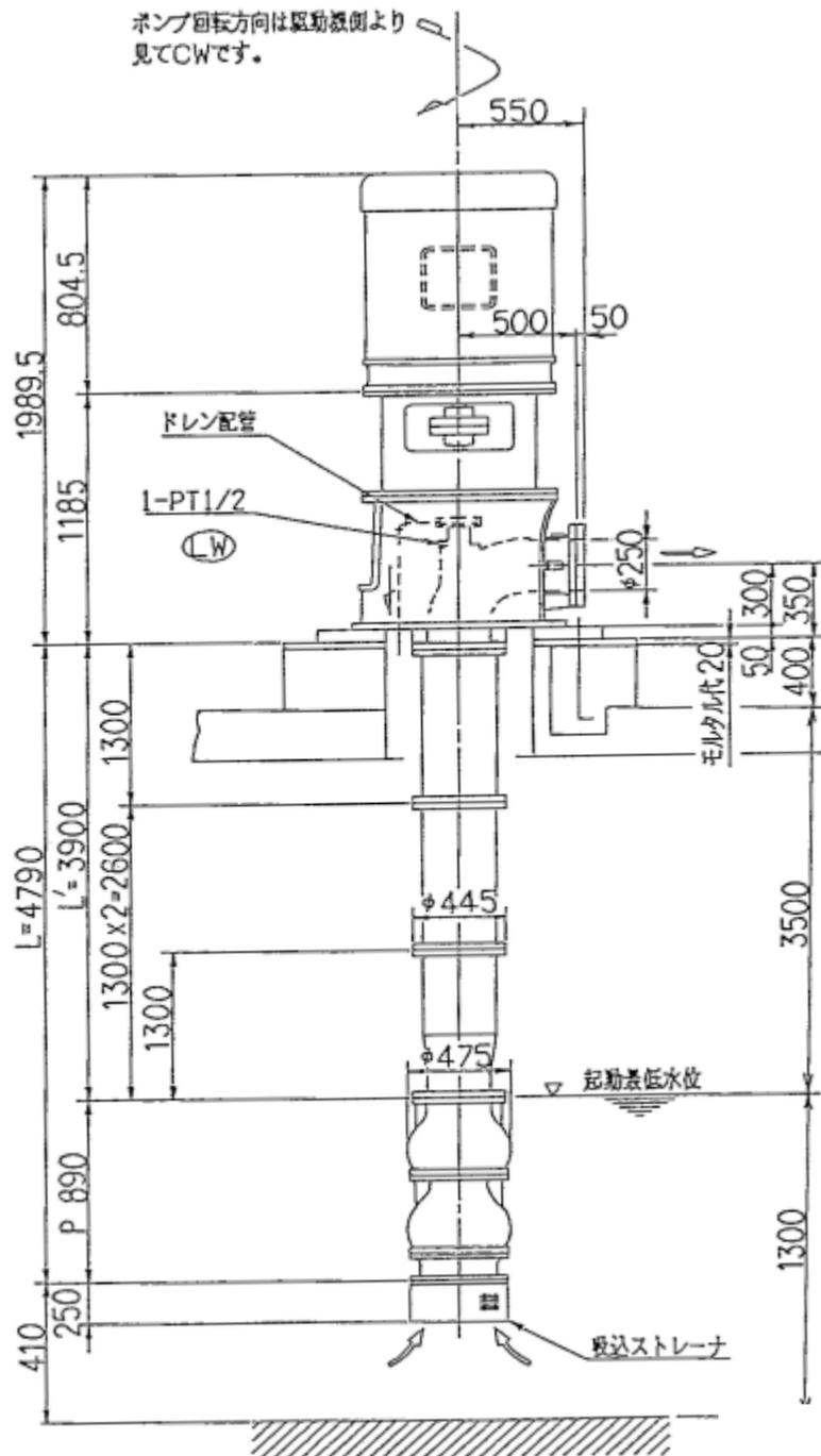
図1 補機系揚水ポンプ外形図
