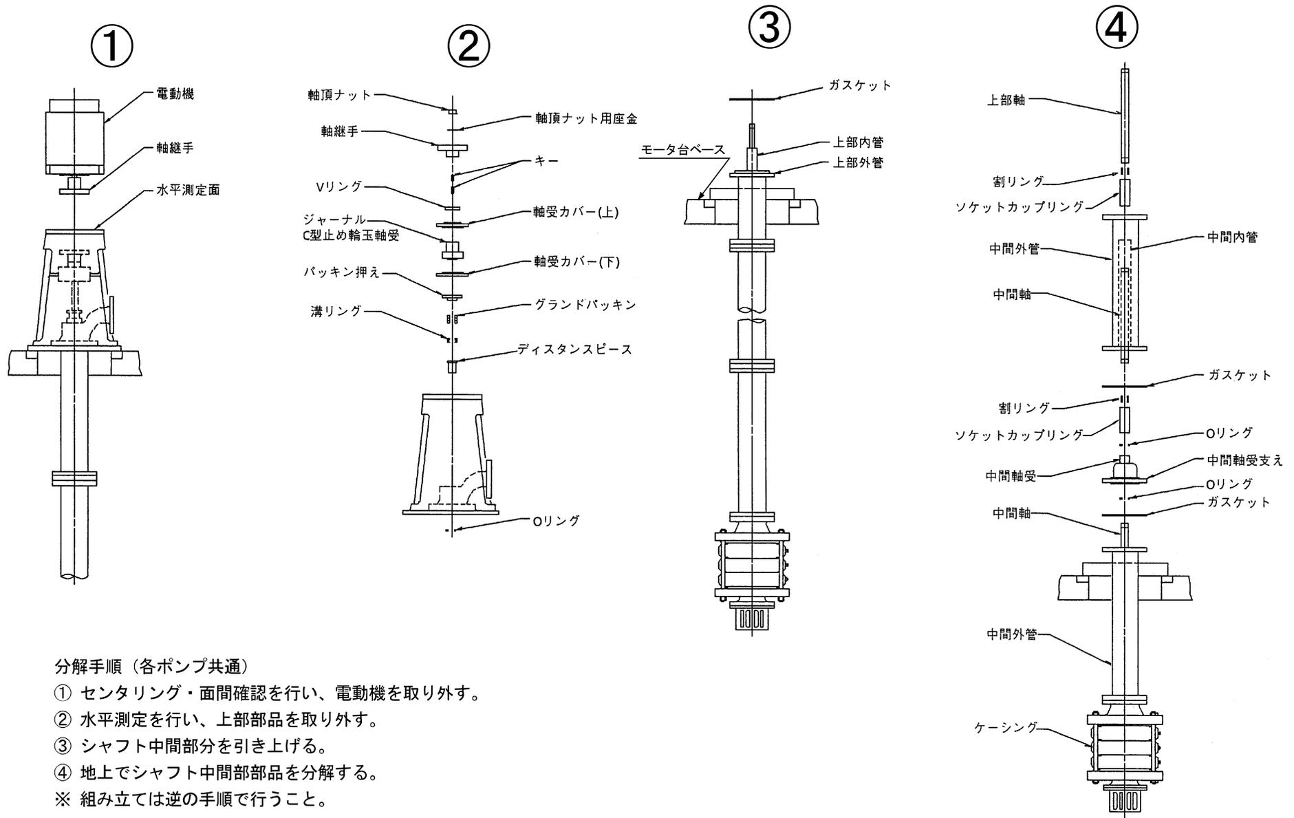
図2 立軸ポンプ分解手順概略図
