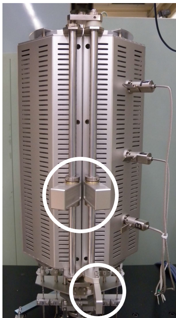
写真 1 高温加熱炉の遠隔操作部
