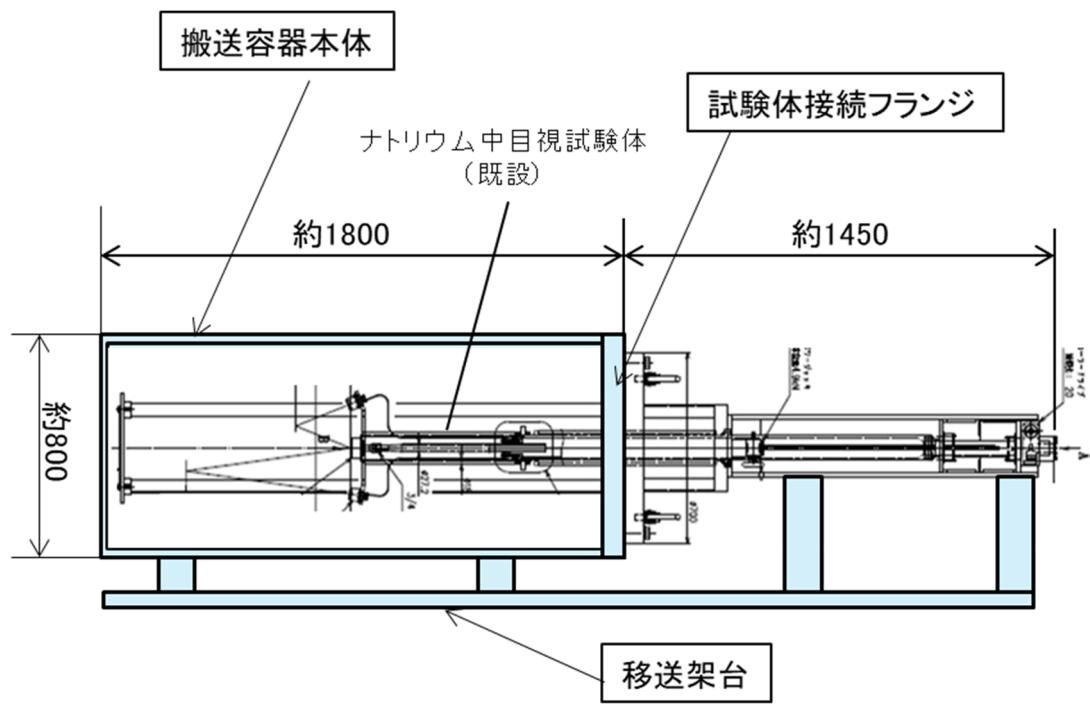
図-1 試験体搬送治具の構成概念
