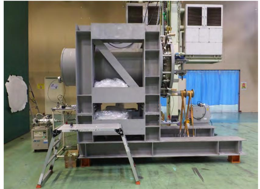
(b) ヘリウムベッセル模擬試験体
