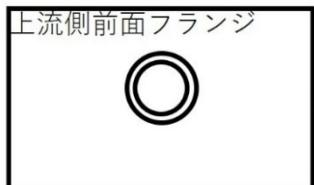
上流側フランジには、中性子窓がフランジを介して取り付けられるよう加工する
