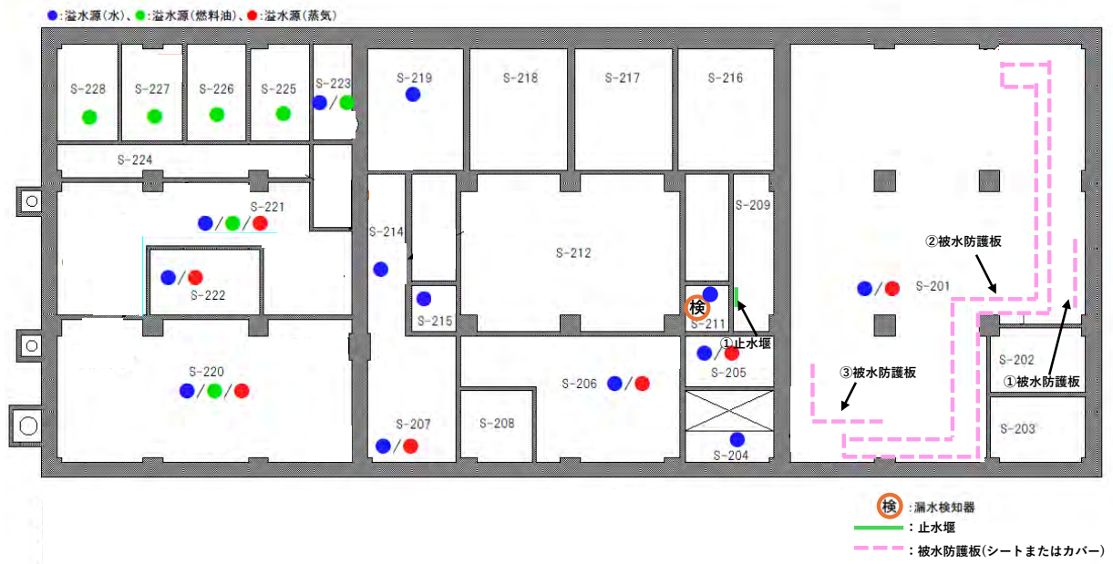
図-7 止水堰、被水防護板等及び検知器の配置計画（主冷却機建物 地下1階）
