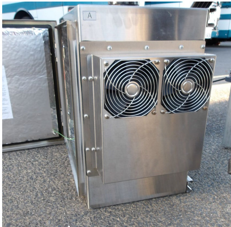
写真4 付属電源盤側面ファン部
