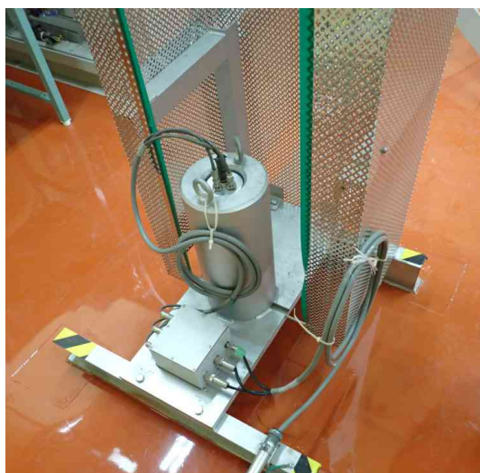
図 4 : 1 次ヘリウムサンプリング設備 \gamma 線検出器
