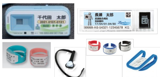
外部の線量測定サービス会社から供給される 個人線量計の例（検出素子はTLD、ガラス、 OSL、固体飛跡検出器など社によって異なる）
